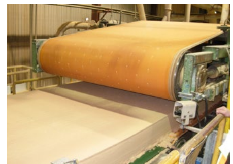
Ein nahtloses endlos gewebtes Vorpressband in Betrieb
