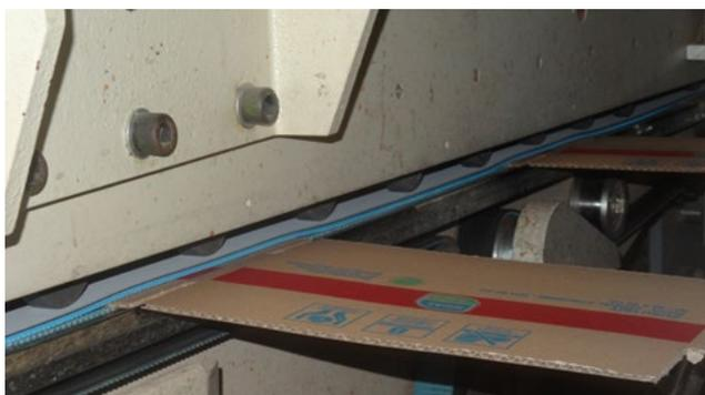
Ausgezeichnete Haftung bei Karton und höherer Ausstoß dank verschleißfester XNBR-Elastomer-Beschichtung mit P6-Struktur.
