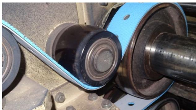
Zugträger aus Polyamidfolie mit hoher Flexibilität und Kantenstabilität.
